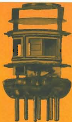
Fig. 2 - In a), Porzione della griglia a quadro del triodo PC 88 (ingrandimento 20x). Si vedono distintamente il catodo, i supporti di griglia e la « trama » della griglia stessa. Per mettere in evidenza le dimensioni del filo di griglia e del passo delle spire abbiamo riprodotto in b) il triodo PC 88 (già ingrandito due volte), sulla griglia del quale è stato tracciato un piccolo rettangolo racchiudente la porzione di griglia ingrandita.
